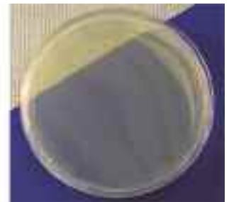
Laminat z powłoką nanosilver brak rozwoju bakterii zarówno po 6, jak i po 18 godzinach
